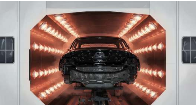
도장 오븐 자동차 도장막을 균일하고 신속하게 건조 및 경화
